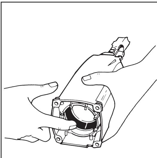
**NOTA:** Después de que haya vuelto a armar completamente la herramienta y de que haya apretado todos los tornillos, compruebe si la herramienta funciona correctamente. Es posible que vea salir algo de humo de los puertos de escape durante los primeros ciclos, mientras se quema el exceso de aceite. Revise el manual del propietario para consultar las instrucciones de avenias en la herramienta.
